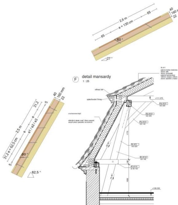
Obr. 4) Sklon střešního pláště ovlivňuje počet vrutů a jejich vzájemnou osovou vzdálenost
