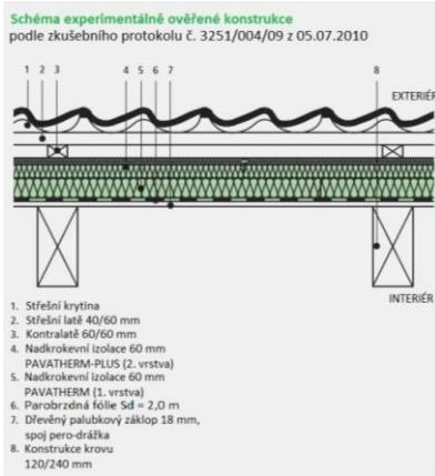
Mnohé testy a experimentální ověřování v notifikovaných zkušebnách (ať už českých, tak i zahraničních) prokazují velice dobré požární odolnosti celých konstrukcí. I když jsou dřevovláknité izolace klasifikovány jako normální hořlavé stavební materiály, (klasifikace podle EN 13501-1; třída reakce na oheň E), tak významným způsobem přispívají k odolnosti konstrukcí vůči požáru. A to bez ohledu na to, zda se jedná o střechu, stěnu, nebo strop.
