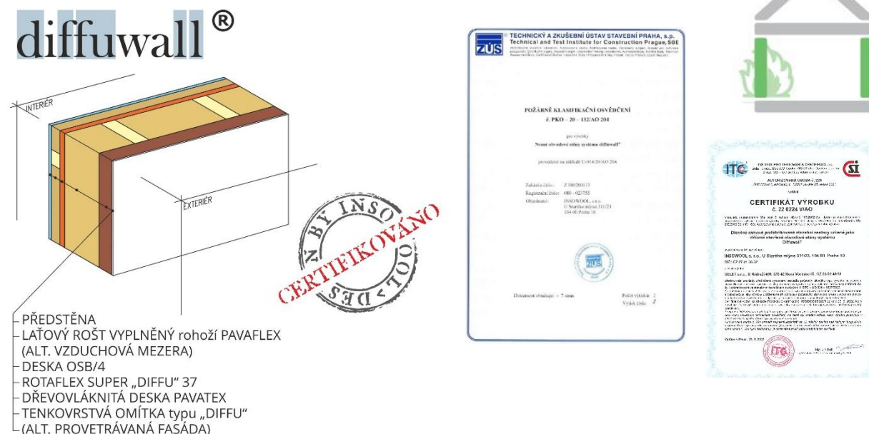
Obr. 14 : Konstrukce Diffuwall®
