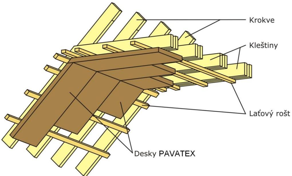
**Obr .2 :** Schéma kladení desek PAVATEX na laťový rošt, desky ve směru krovkí, spoje „na vazbu“
