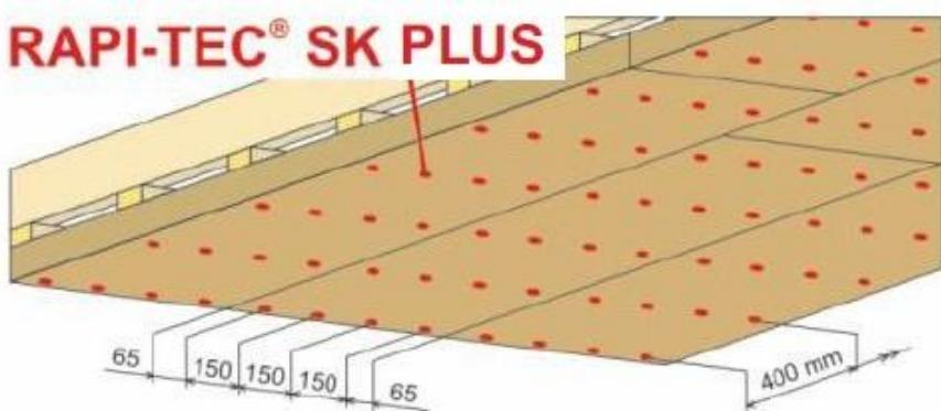
Obr. 4 : Schéma kotvení desek PAVATEX do latí
