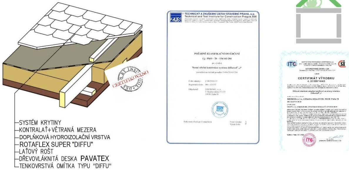
Obr. 8 : Konstrukce Diffuroof® „I“
