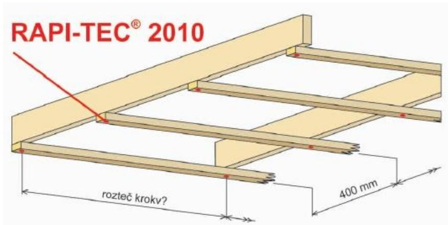
**Obr. 3 :** Schéma kotvení laťového roštu do krovkí nebo kleštin
